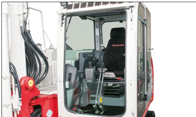
Cabina insonorizada, pobre en vibraciones con compartimentos para guardar cosas.
