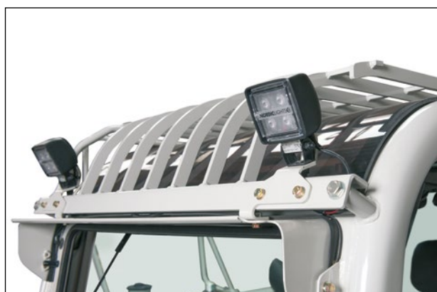
Faros de LED para iluminación óptima por la noche y en obras subterráneas.
