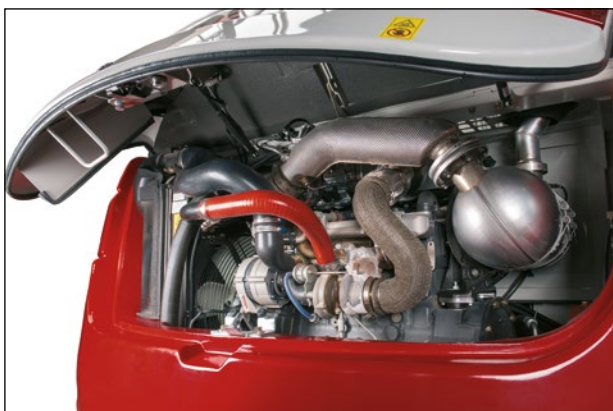
Amplias tapas de mantenimiento para un acceso cómodo a los componentes hidráulicos y al motor.
