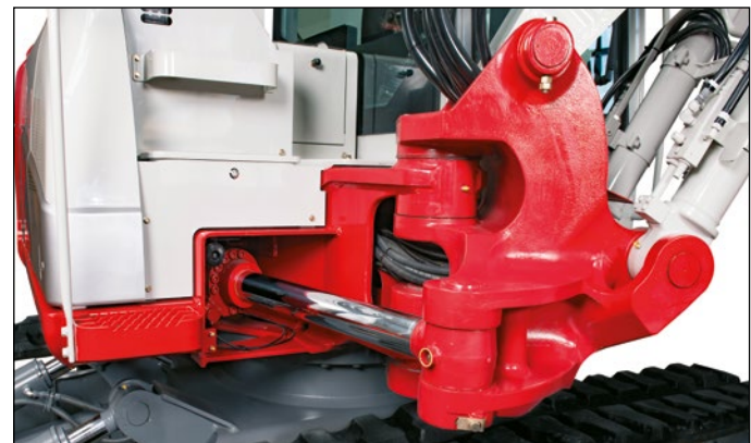
Bloque de giro robusto con latiguillos protegidos y giro de brazo hidráulico.
