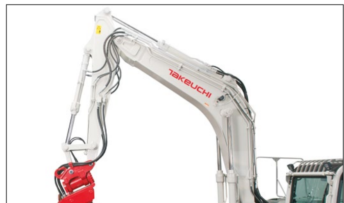
4 circuitos auxiliares, 3 de ellos dirigidos por potenciómetros, presiones y caudales regulables.
