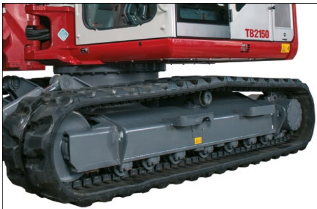
Rodillos con doble guía y rueda guía robusta.
